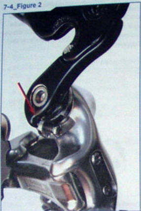
Derailleur stop screw contacting the hanger tab
