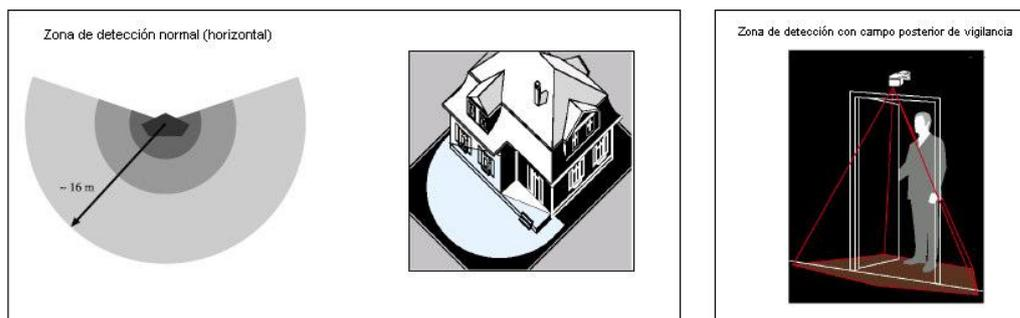
**Figura 61:** Radio de actuación del sensor.
