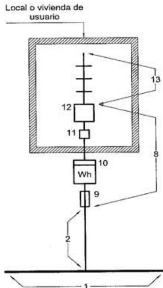
Figura 1: Esquema de instalación para un solo usuario
