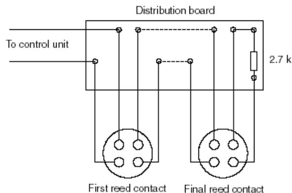
**Figura 57:** Conexión entre sensores magnéticos.
