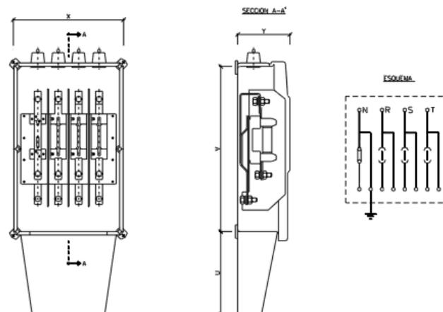
**Figura 1.** Caja de seccionamiento y esquema eléctrico.
