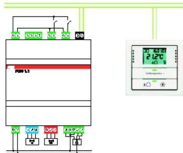
**Figura 65:** Conexión del controlador de fan coil
