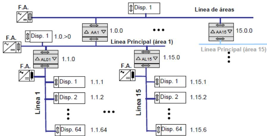
**Figura 22.** Ejemplo de direccionamiento físico
