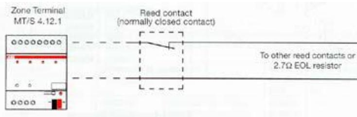
**Figura 56:** Conexión de sensores magnéticos.
