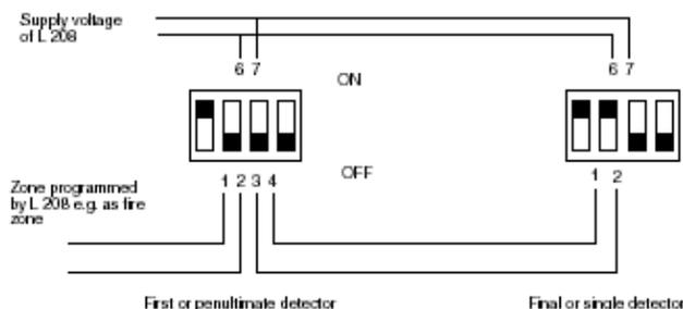
**Figura 64:** Conexión sensor de fuga de gas.
