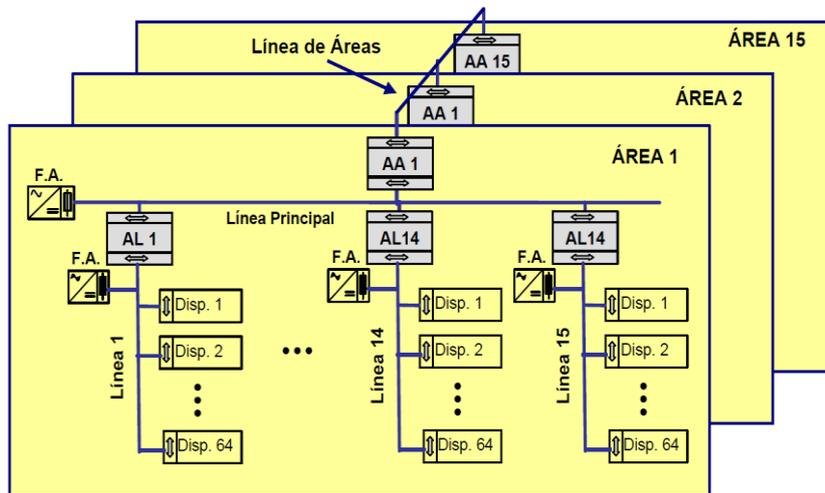
**Figura 21.** Topología de una instalación EIB
