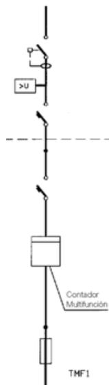
**Figura 3.** Esquema unifilar CPM-TMF1
