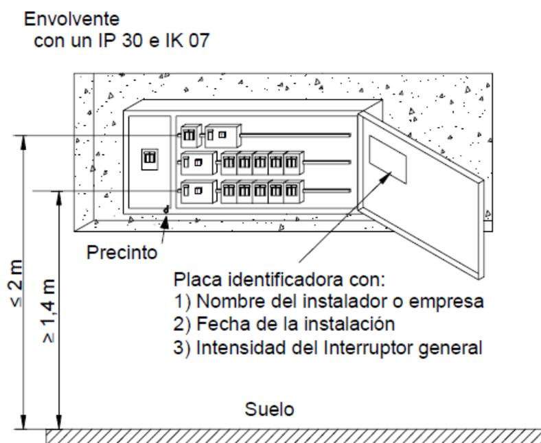
Figura 4: Ejemplo de instalación de cuadro general de mando y protección.
