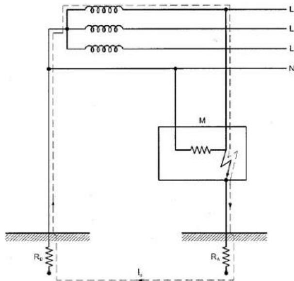
Figura 5: Conexión típica de un esquema TT
