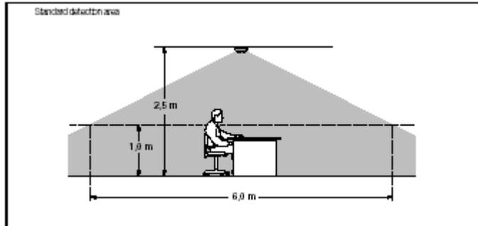
**Figura 59:** Radio de actuación del detector.
