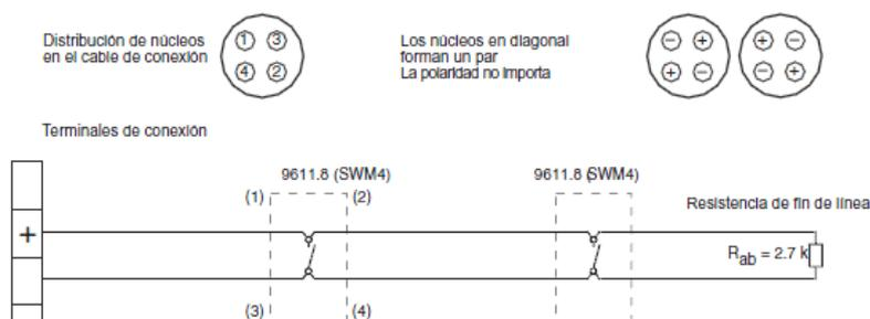
**Figura 63:** Conexión de detectores de fuga.
