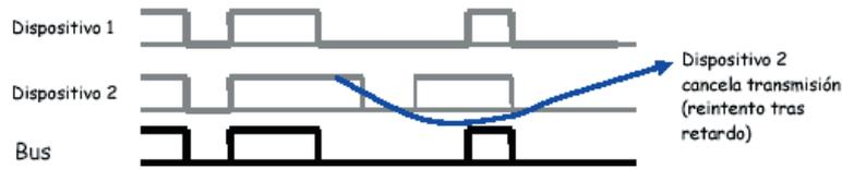
**Figura 24.** Resolución de colisiones CSMA/CA
