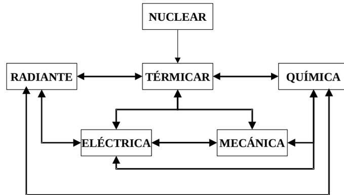
En la práctica ninguna de estas transformaciones se realizan con un 100% de rendimiento siempre se produce unas pérdidas de energía como puede ser el trabajo de rozamiento en los pistones de un motor, o la pérdidas por calentamiento de un alternador, etc. El rendimiento de una transformación viene dado por la expresión:
