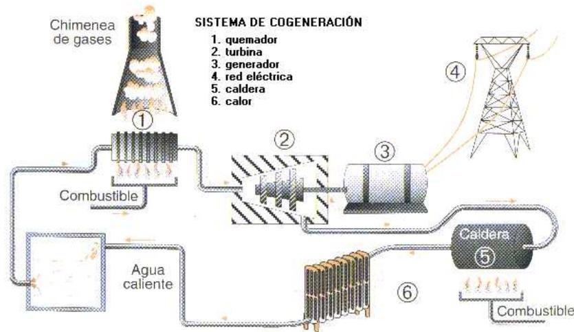
El desarrollo de los ciclos combinados obedece al aprovechamiento que se puede realizar en un ciclo termodinámico de un fluido del calor que se desprende en una parte del mismo e invertirlo en cederlo a otro ciclo, de otro fluido de propiedades termodinámicas diferentes, en la parte en que éste último precise una aportación de calor.
