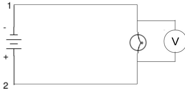
Recordemos que la corriente (intensidad) eléctrica en nuestro circuito de ejemplo es igual en cualquier punto del circuito, mientras que la caída de tensión que podemos medir, depende del lugar en el que la midamos.
