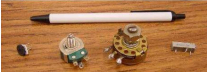
Dado que las resistencias disipan energía térmica cuando las corrientes eléctricas que las atraviesan superan la "fricción" a su paso, también se clasifican según de la cantidad de energía térmica que son capaces de disipar sin sobrecalentarse ni sufrir daños.
