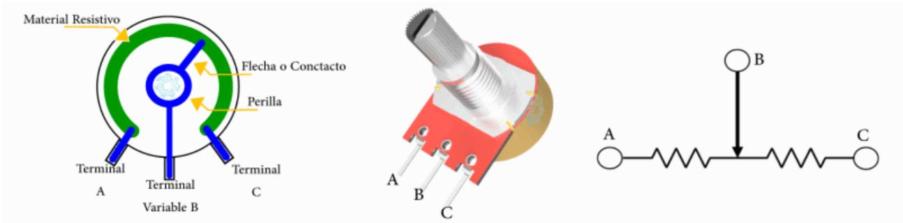
Un potenciómetro dispone de tres contactos. En el potenciómetro de la imagen, los contactos A y C son fijos y entre ellos se mide la resistencia total ( $R_{AC}$ ). El contacto B es deslizante y permite ajustar un valor de resistencia respecto al contacto A ( $R_{AB}$ ). El valor de resistencia del contacto B respecto al contacto C está dado por:  $R_{BC} = R_{AC} - R_{AB}$ .
