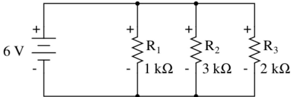
En la conexión en paralelo, los voltajes de las resistencias son iguales, 6 V. El resultado se representa en la siguiente tabla.
