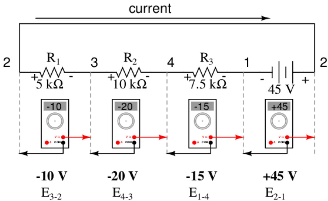
Que la tensión entre el polo positivo de la primera resistencia y el de la batería sea 0 V, resulta lógico. Observando el circuito, podemos ver que el extremo izquierdo de la conexión (lado izquierdo de R 1 : punto número 2) está conectado directamente al extremo derecho de la conexión (lado derecho de la pila: punto número 2). Estos dos puntos son eléctricamente comunes entre sí. La tensión entre dos puntos eléctricamente comunes debe ser cero.
