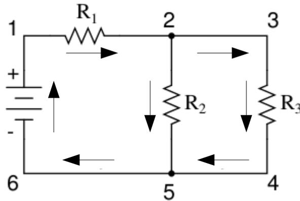
En este circuito, tenemos dos lazos por los que fluyen la corriente: uno de 1 a 2 a 5 a 6 y de nuevo a 1. Otro de 1 a 2 a 3 a 4 a 5 a 6 y de vuelta a 1 otra vez. En ambos caminos la corriente pasan por  $R_1$  (del punto 2 al punto 1). En esta configuración, se dice que  $R_2$  y  $R_3$  están en paralelo entre sí, mientras que  $R_1$  está en serie con la combinación en paralelo de  $R_2$  y  $R_3$ .
