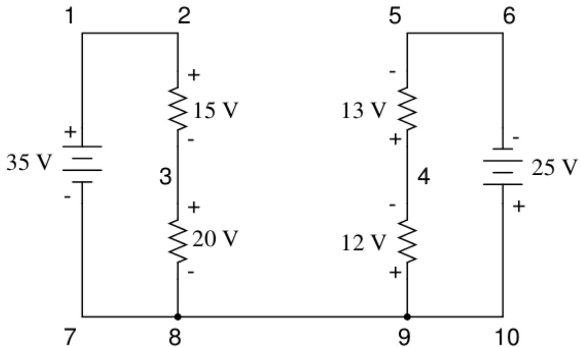
El circuito de la imagen está compuesto por dos conexiones en serie, unidas por un conductor. Para determinar el voltaje entre los puntos 4 y 3, se observa la malla 3, 4, 9, 8, 3.
