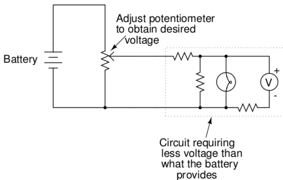
Utilizado de esta manera, el nombre potenciómetro cobra sentido, ya que controla el potencial (tensión), creando una relación divisora de voltaje variable. Este uso del potenciómetro de tres contactos como divisor de tensión variable es muy popular en el diseño de circuitos.
