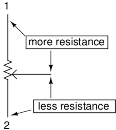
La flecha dibujada en el centro de la resistencia representa el contacto deslizante. A medida que se desplaza hacia abajo, acercándose al contacto 2, se reduce la resistencia entre 2 y el contacto deslizante, mientras que aumenta con respecto a 1. La resistencia entre los contactos 1 y 2 es constante, independientemente de la posición del contacto deslizante.
