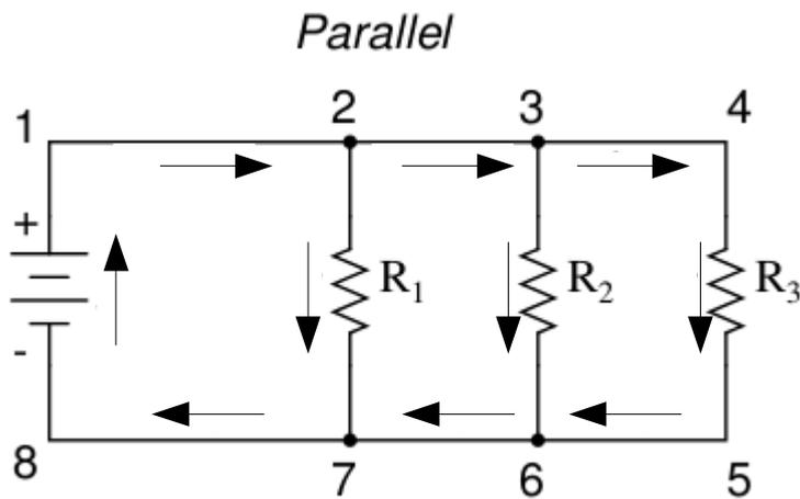
Vuelve a ser un circuito compuesto por tres resistencias, pero esta vez los conductores forman unos lazos o bucles. La característica de la conexión en paralelo es que la corriente se reparte en las conexiones de los cables conductores (nodos).
