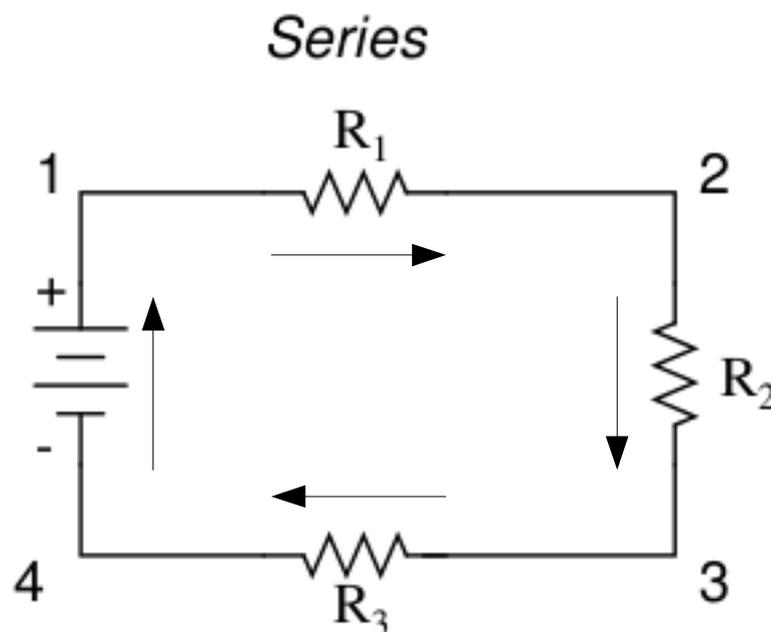
Este circuito está compuesto por tres resistencias,  $R_1$ ,  $R_2$  y  $R_3$ , formando una línea que conecta el polo positivo de la batería con el negativo. Los subíndices no están relacionados con los valores de las resistencias en ohmios, su función es identificar las resistencias.
