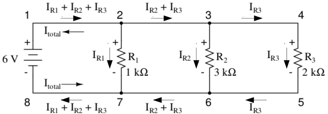
En cada nudo del "raíl" positivo (conductor 1-2-3-4) una parte de la corriente se separa del flujo principal, circulando por una resistencia.
