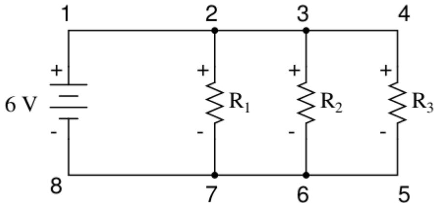
En el circuito con conexión en paralelo, en cada resistencia la caída de tensión es de 6 V.
