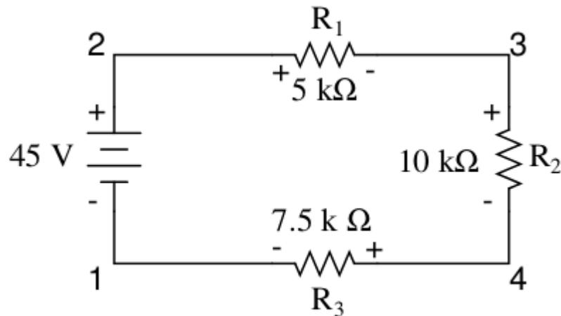
Si conectáramos un voltímetro entre los puntos 2 y 1, la sonda de medición roja tocando el punto 2 y la negra el punto 1, el voltímetro mostraría +45 voltios.
