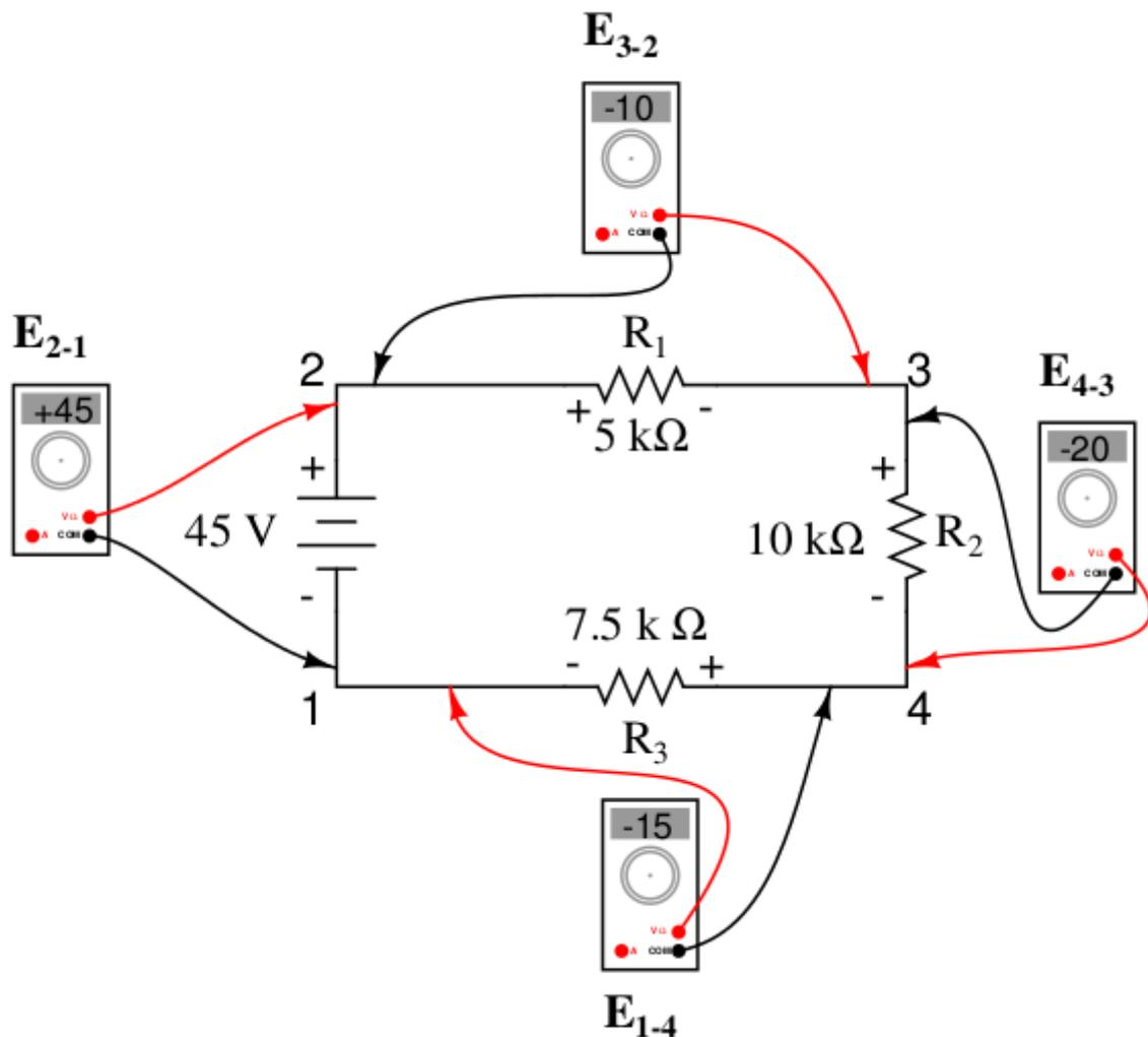
Ya deberíamos estar familiarizados con el principio general de los circuitos en serie según el cual las caídas de tensión individuales suman a la tensión de alimentación.
