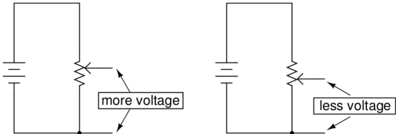
La relación de la división de tensión del potenciómetro es una función de la resistencia y no del valor de tensión aplicado. Si el contacto deslizante del potenciómetro se mueve a la posición del 50 por ciento (centro exacto), la caída de tensión hacia los otros dos contactos (exteriores), es la misma y será la mitad de la tensión que se mide entre los contactos exteriores.
