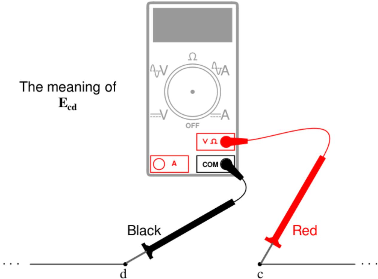
Si tomáramos el polímetro y midiéramos la caída de tensión a través de cada resistencia, recorriendo el circuito en el sentido de las agujas del reloj, avanzando con la sonda roja un punto por delante de la sonda negra, obtendríamos las siguientes lecturas.
