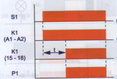
Figura 11.48. Temporizador a la conexión.
