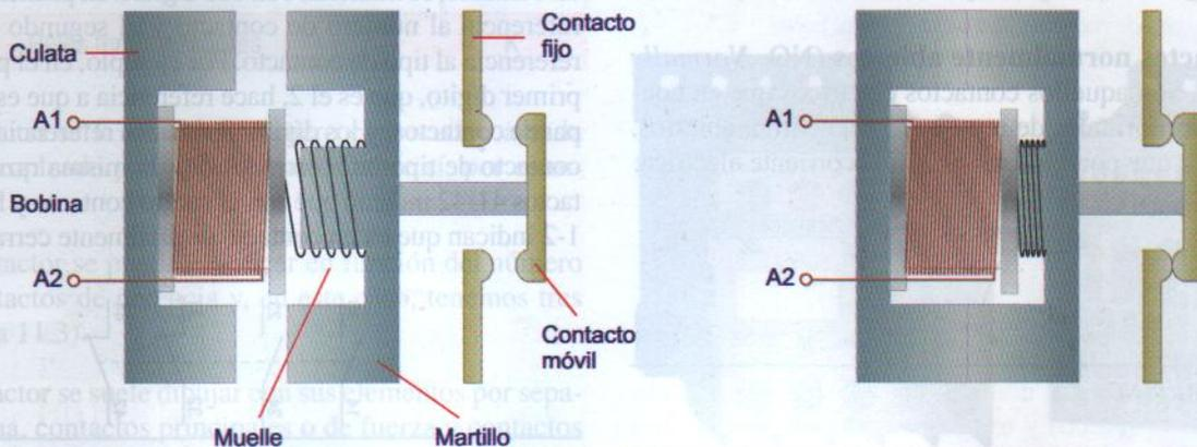
Figura 11.5. Partes internas de un contactor. Sin activar y activado.
