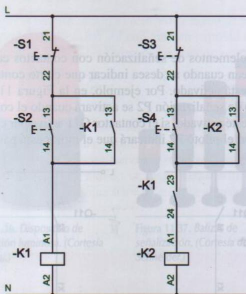
Figura 11.43. Ejemplo de condición.
