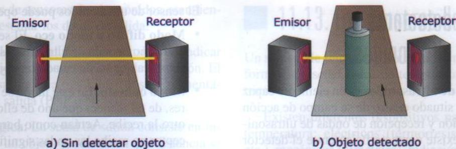
Figura 11.61. Funcionamiento del método de detección por bloqueo de haz.
