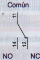
Figura 11.20. Símbolo de un contacto conmutado.
