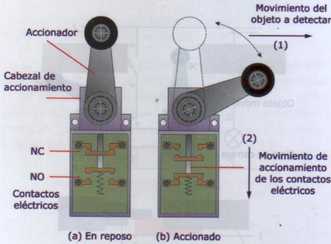
Figura 11.53. Detalle de un interruptor de posición.
