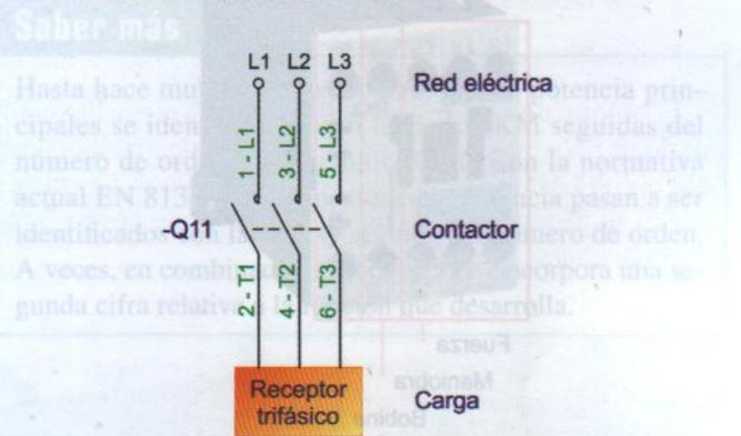
Figura 11.6. Conexión de un contactor con una carga.
