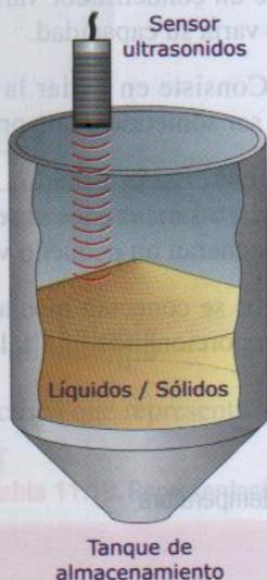
Figura 11.67. Control de capacidad mediante sensor de ultrasonidos.
