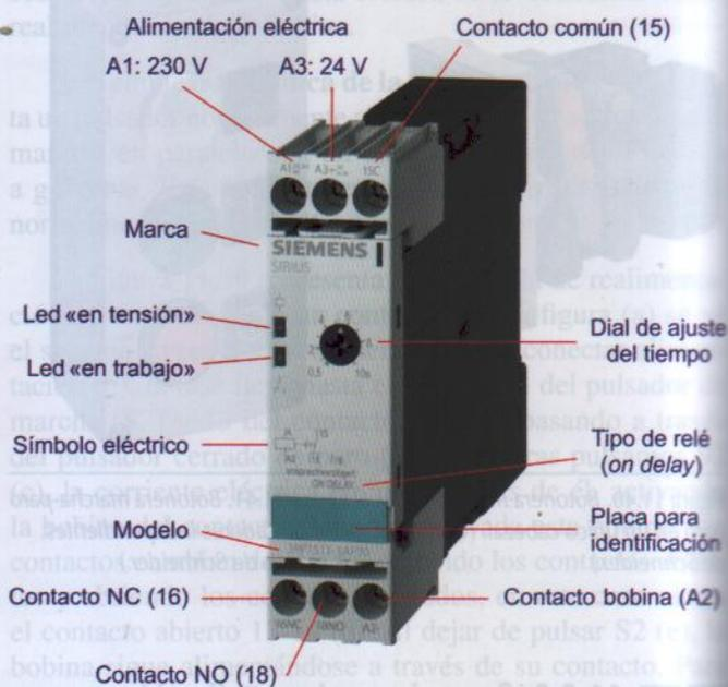
Figura 11.45. Partes de un relé temporizador.
