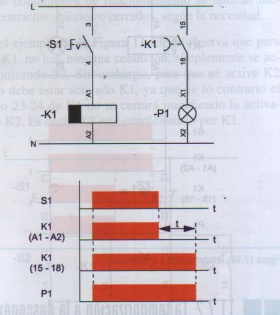
Figura 11.49. Temporizador a la desconexión.
