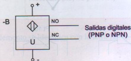
Figura 11.68. Conexión a cuatro hilos (salida digital).
