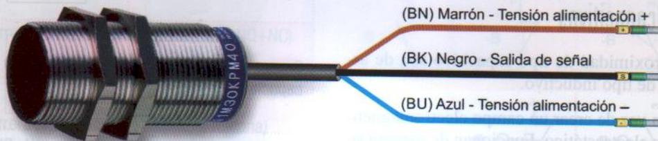
Figura 11.59. Cableado en un sensor de proximidad.
