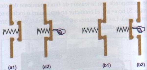
Figura 11.10. Accionamiento sobre unos contactos NO (a1 en reposo, a2 accionado) y NC (b).
