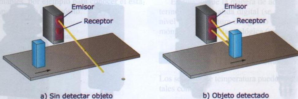
Figura 11.62. Funcionamiento del método de detección por retorno de haz.
