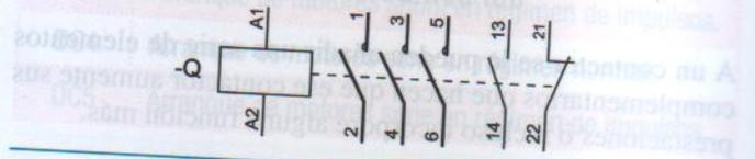
**Figura 11.12.** Representación gráfica de un contactor de potencia.
