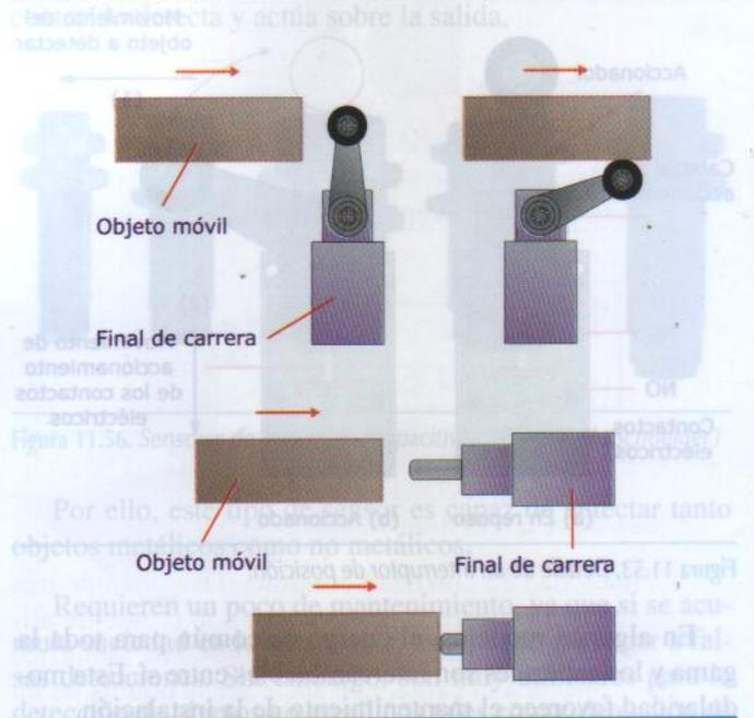
Figura 11.52. Funcionamiento de la detección del final de carrera.
