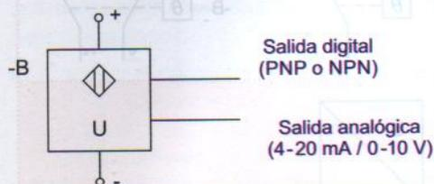
Figura 11.69. Conexión a cuatro hilos con doble salida (analógica y digital).
