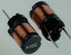
Figura 2.16. Bobinas con núcleo de ferrita de 1000 µH.
