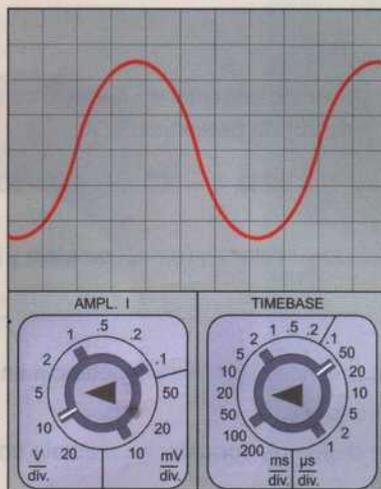
Figura 4.86. Señal visualizada en el osciloscopio.
