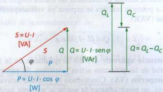
Figura 4.27. Triángulo de potencias.
