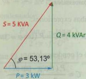
Figura 4.28. Triángulo de potencias.
