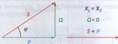
Figura 4.29. Mejora del triángulo de potencias.
