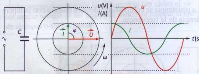
Figura 4.11. Circuito eléctrico de un condensador puro en corriente alterna. Diagrama vectorial y senoidal.
