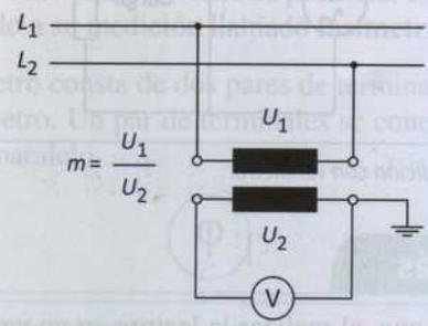
Figura 4.38. Medición de la tensión mediante transformador.
