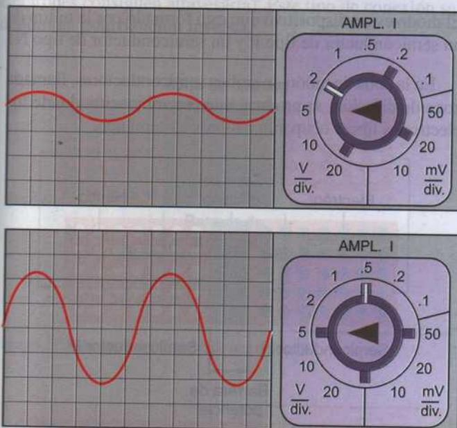
Figura 4.65. Señal visualizada con escalas de amplitud.
