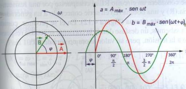
Figura 4.7. Desfase entre dos ondas.
