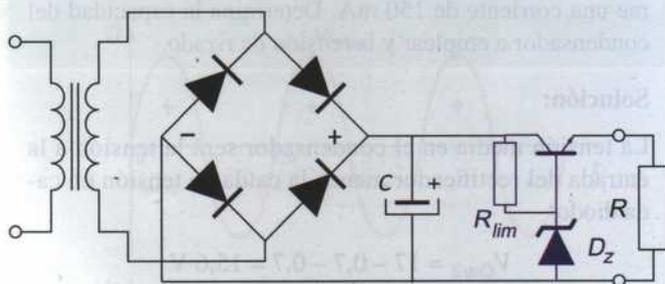
Figura 4.83. Fuente de alimentación con regulador a transistor.
