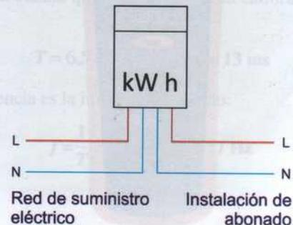
Figura 4.59. Medición con contador de energía activa monofásico.
