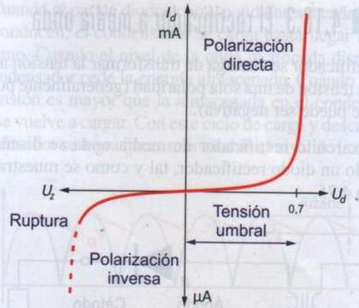
Figura 4.72. Curva característica de un diodo.
