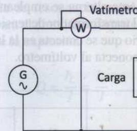
Figura 4.47. Medición con vatímetro.
