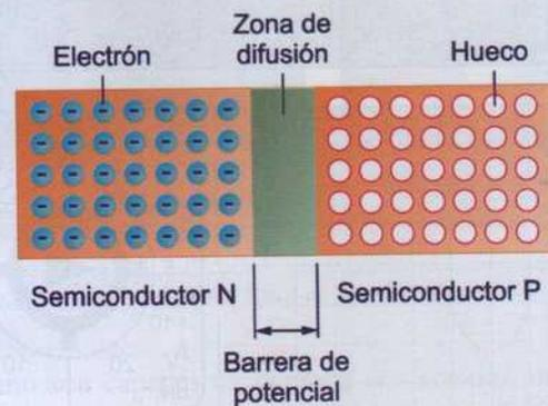
Figura 4.69. Unión PN en un semiconductor.
