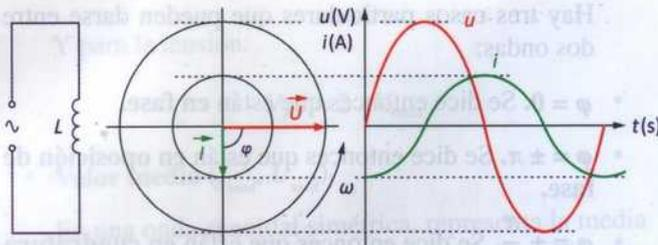
Figura 4.10. Circuito eléctrico de una bobina pura en corriente alterna. Diagrama vectorial y senoidal.
