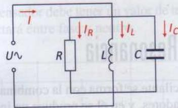
Figura 4.35. Circuito resonante paralelo.
