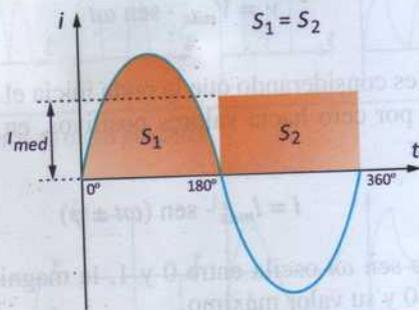
Figura 4.5. Representación del valor medio de la corriente mediante semejanza de áreas.
