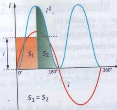
Figura 4.6. Representación del valor eficaz de la corriente mediante semejanza de áreas.
