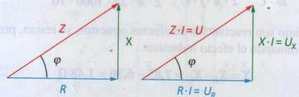
Figura 4.24. Obtención del triángulo de tensiones.
