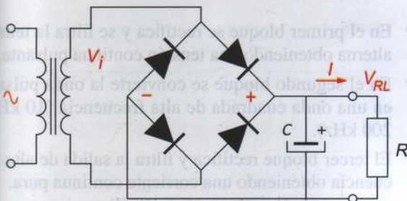
Figura 4.80. Circuito rectificador con filtro.
