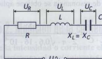
Figura 4.33. Circuito resonante serie.
