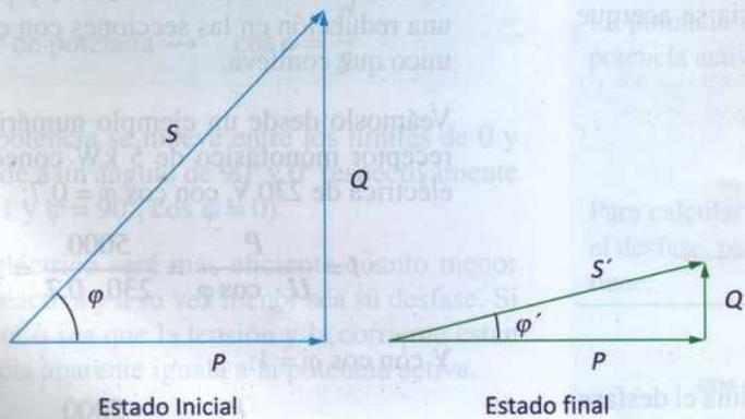
Figura 4.30. Proceso de mejora del factor de potencia.
