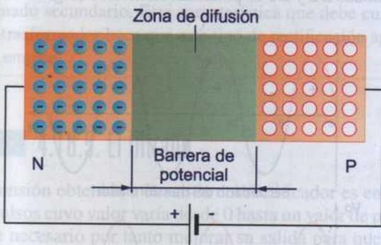
Figura 4.71. Polarización en inverso de una unión PN.
