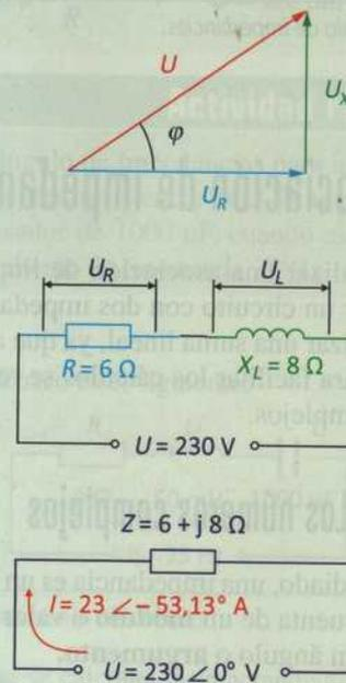
Figura 4.25. Representación de la impedancia y su triángulo de tensiones.
