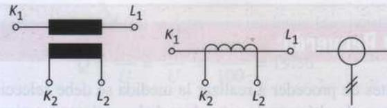
Figura 4.45. Simbología de los transformadores de corriente.
