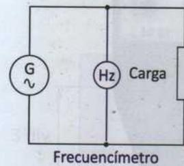
Figura 4.56. Medición con frecuencímetro.
