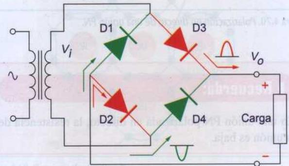
Figura 4.77. Circuito rectificador de onda completa.
