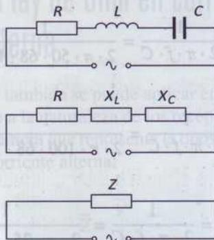
Figura 4.17. Reducción del circuito a impedancia.
