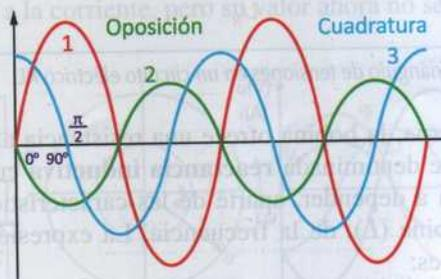
Figura 4.8. Señales en oposición y cuadratura de fase: (1) Señal de referencia, (2) en oposición y (3) en cuadratura.
