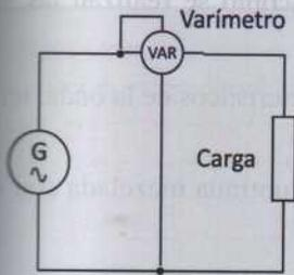
Figura 4.50. Medición con varímetro.
