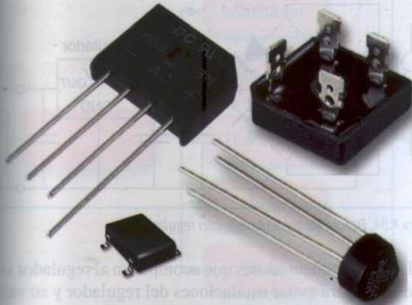
Figura 4.79. Puente rectificador de Graetz.
