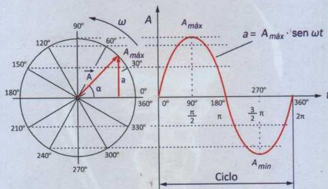
Figura 4.3. Representación de una onda senoidal alterna.
