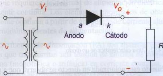
Figura 4.75. Circuito rectificador de media onda.
