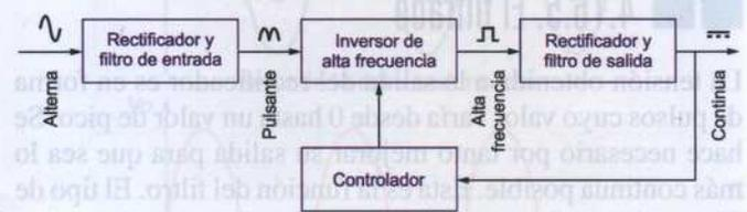
Figura 4.85. Esquema de bloques de una fuente conmutada.
