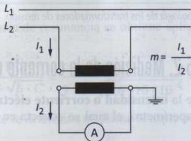
Figura 4.44. Medición de la corriente mediante transformador.
