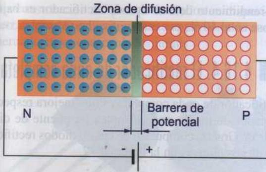
Figura 4.70. Polarización en directo de una unión PN.
