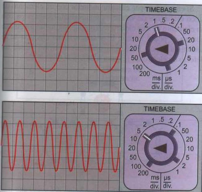
Figura 4.64. Señal visualizada con diferentes bases de tiempos.
