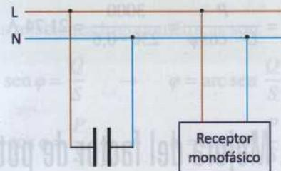
Figura 4.31. Conexión del condensador.
