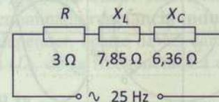
Figura 4.20. Circuito equivalente.
