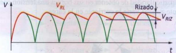
Figura 4.81. Efecto del condensador como filtro.
