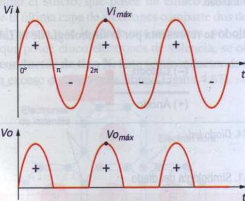
Figura 4.76. Señales en el rectificador de media onda.
