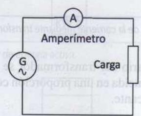
Figura 4.40. Medición con amperímetro.
