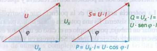
Figura 4.26. Obtención del triángulo de potencias.
