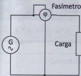
Figura 4.53. Medición con fasímetro.
