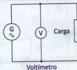
Figura 4.36. Medición de la tensión en alterna con voltímetro.
