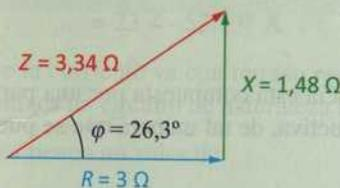
Figura 4.21. Triángulo de impedancias.
