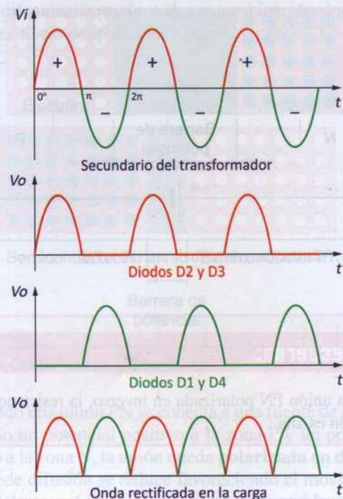
Figura 4.78. Señales en el rectificador de onda completa.
