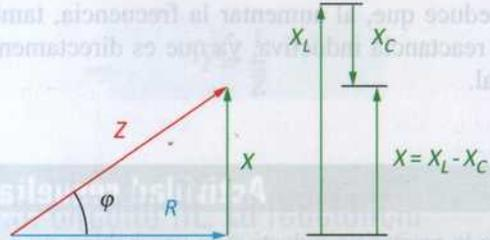
Figura 4.18. Triángulo de impedancias.
