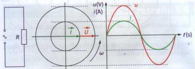
Figura 4.9. Circuito eléctrico de la resistencia en corriente alterna. Diagrama vectorial y senoidal.
