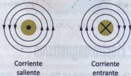
Figura 5.9. Representación del sentido de la corriente en un plano o dibujo.
