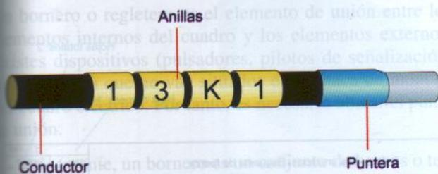
Figura 8.18. Numeración de conductores mediante destino.
