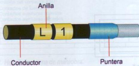
Figura 8.17. Numeración de conductores con anillas.
