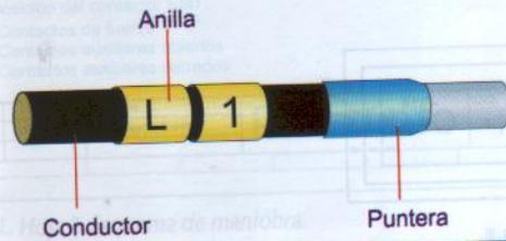
Figura 8.17. Numeración de conductores con anillas.
