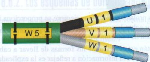
Figura 8.31. Etiquetaje de manguera.
