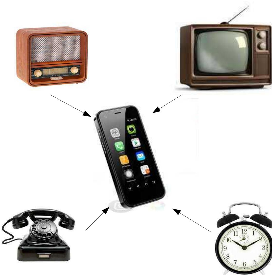
Un dispositivo con microprocesador permite realizar las funciones de diversos dispositivos con componentes no programables
