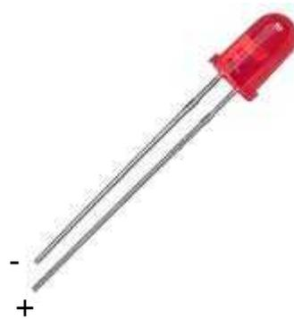
Además se debe limitar la corriente que circula por el LED a aproximadamente 20 mA. Si se utiliza la tensión de alimentación de 5 V disponible en la placa Arduino, la resistencia necesaria para
