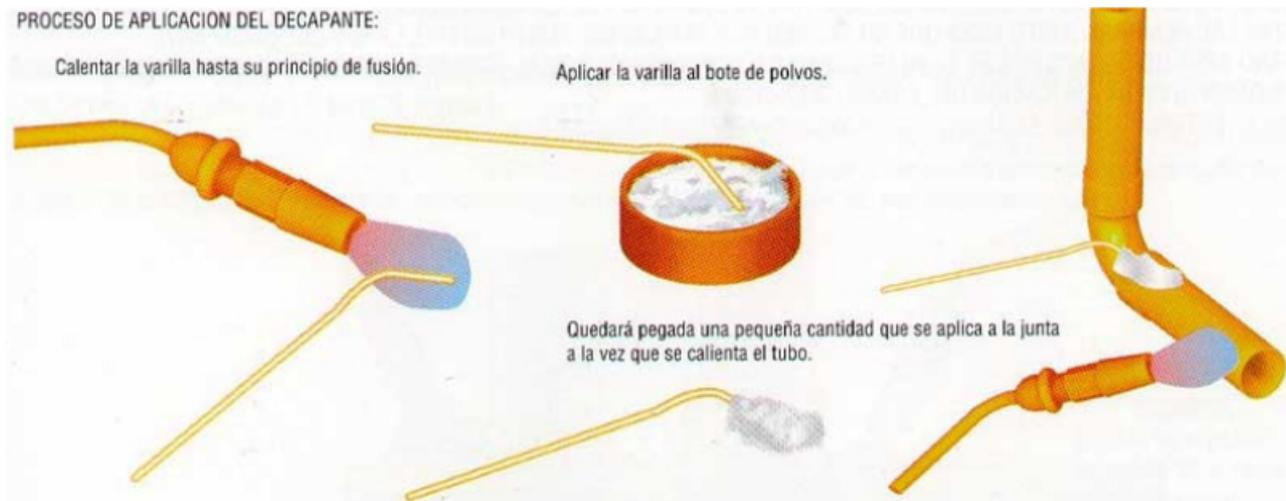
Manteniendo la llama en movimiento para evitar quemar el cobre, se calienta la unión hasta que el decapante se vuelve transparente, la varilla se funde y penetra en la el intersticio de la unión.
