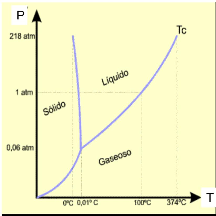
En el diagrama de fases del agua se observa la dependencia de la temperatura del cambio de fase y la presión.
