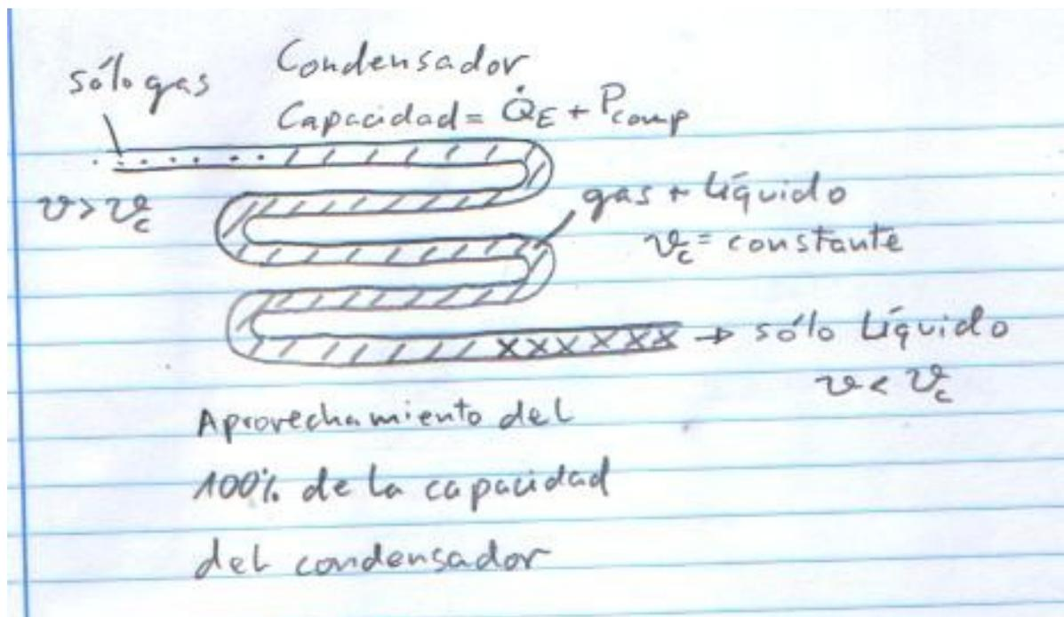
Si  $Capacidad > \dot{Q}_E + P_{comp}$ , el condensador está sobredimensionado y podría ceder más calor del que el refrigerante está aportando. El refrigerante entra en el condensador como gas a la temperatura de condensación y termina de condensar antes de llegar a la salida. Durante el último tramo del
