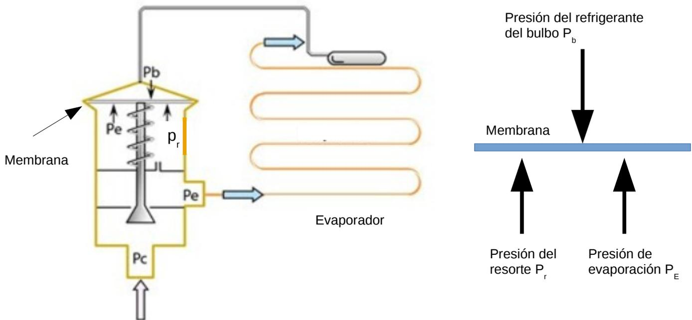
La válvula mostrada en este esquema se llama de igualación interna de presión, porque en su interior dispone de orificios que permiten que la presión en su salida al evaporador actúe sobre la membrana.
