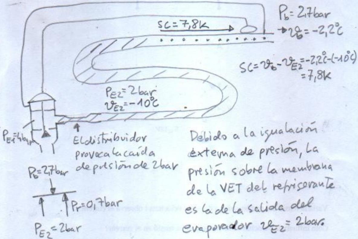
Para mantener el equilibrio de presiones en la membrana,  $P_b = 2,7 \text{ bar}$  es suficiente. La temperatura del bulbo correspondiente es  $-2,2^\circ \text{C}$ . Así, el sobrecalentamiento necesario para mantener en equilibrio la válvula es de  $7,8 \text{ K}$ .
