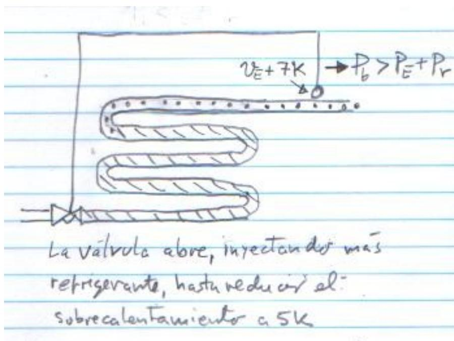
Si baja la temperatura del recinto refrigerado, se reduce la cantidad de calor que absorbe el evaporador y el refrigerante líquido evapora más despacio. El tramo del evaporador con gas sobrecalentado se reduce. El sobrecalentamiento en la posición del bulbo desciende, por ejemplo a 3 K. Esta reducción causa una bajada de la presión del refrigerante en su interior. Ahora
