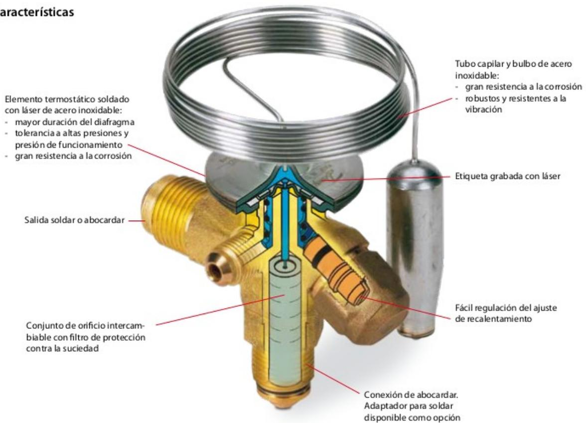
En el cabezal termostático de la válvula, actúan tres presiones sobre una membrana. La presión del refrigerante contenido en el bulbo,  $p_b$ , depende de la temperatura del bulbo. A la fuerza causada por  $p_b$ , se oponen, actuando sobre la misma membrana, las fuerzas causadas por la presión de evaporación  $p_E$  y la presión de un resorte  $p_r$ .
