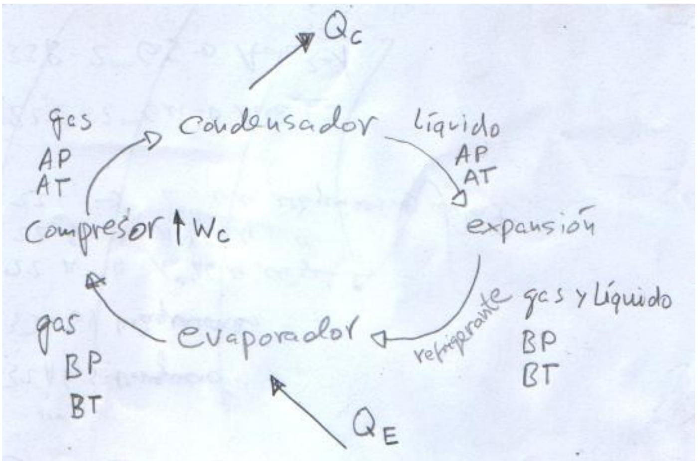
El refrigerante absorbe calor del medio exterior en el evaporador.
