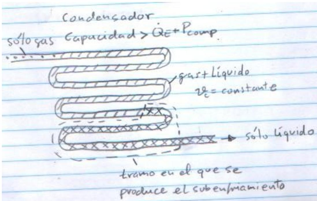
En el caso de  $Capacidad < \dot{Q}_E + P_{comp}$  el condensador no es capaz de ceder la energía del refrigerante hasta condensarlo por completo. La presión y temperatura de condensación aumentan. El caudal de masa del refrigerante se reduce, debido al aumento de diferencia entre alta y baja presión. El condensador limita la potencia frigorífica de la instalación.
