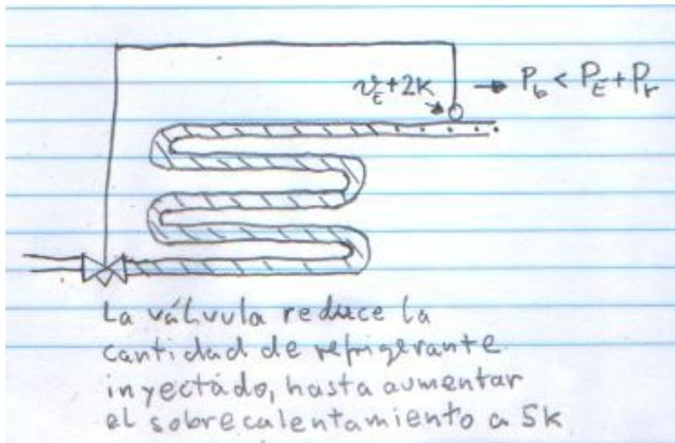
El sobrecalentamiento causado por la válvula se puede ajustar variando la presión que el resorte ejerce sobre la membrana.
