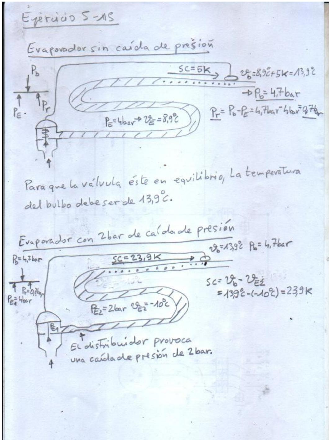
Evaporador con caída de presión de 2 bar y válvula con igualación externa de presión
