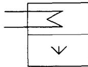
**9.2 Vaso de expansión con membrana y compresor de aire**
