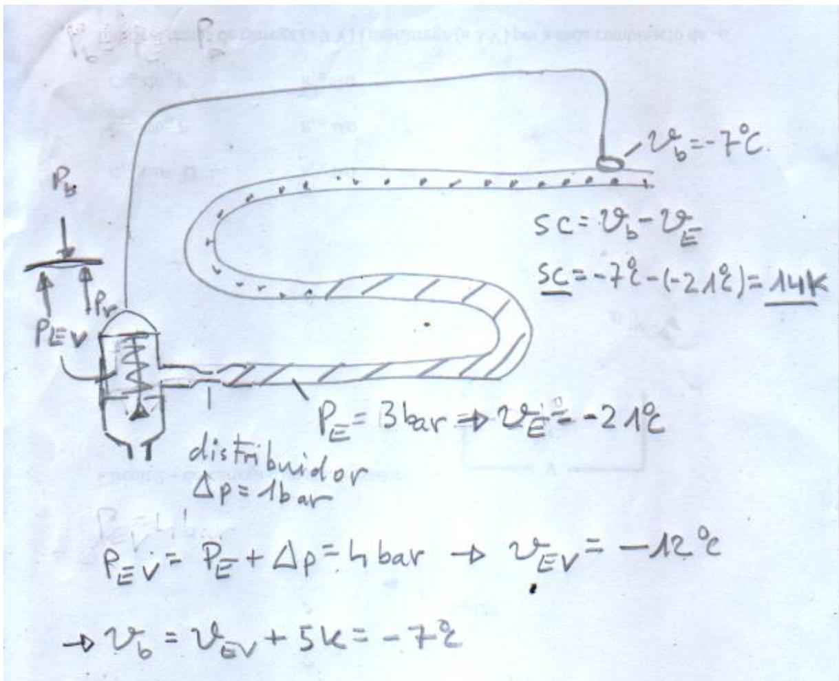
En el evaporador se produce un sobrecalentamiento de 14 K.
