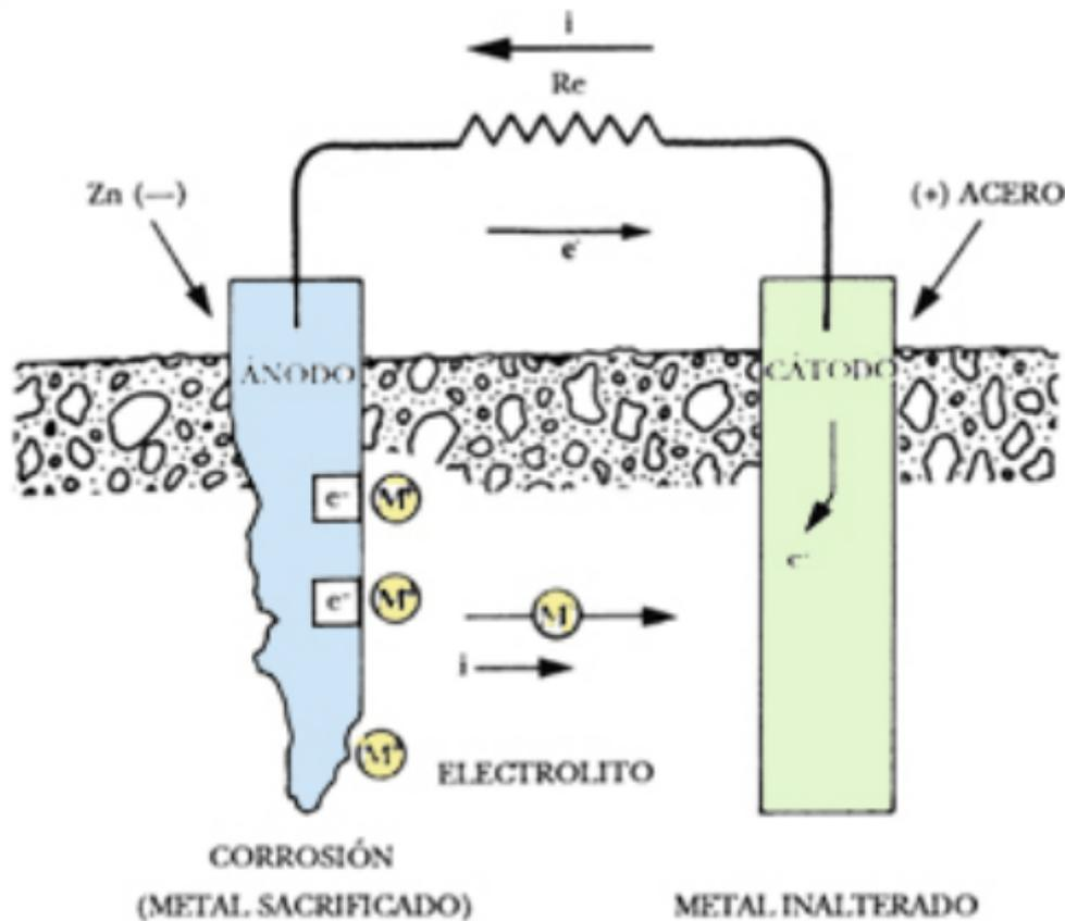
Cuando dos sistemas se ponen en contacto eléctrico el más \_\_\_\_\_ se oxida cediendo \_\_\_\_\_ al menos electronegativo. En este caso el ánodo de sacrificio, \_\_\_\_\_ electronegativo, se oxida comunicando los electrones liberados en este proceso al metal a \_\_\_\_\_.
