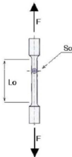
$L_0$  es la longitud inicial,  $S_0$  es la sección inicial y  $D_0$  es el diámetro inicial de la probeta. Para llevar a cabo el ensayo de tracción, las anteriores variables pueden tomar los siguientes valores:
