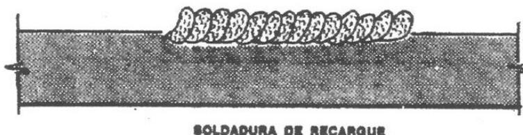
Se suele utilizar para el rectificado de ejes y los cordones habrá que ejecutarlos alternamente (paso peregrino), para evitar deformaciones debido a las tensiones producidas por altas temperaturas que origina la soldadura. Al a ver aumentado su diámetro con los cordones de soldadura procederíamos a su rectificado en la maquina adecuada.
