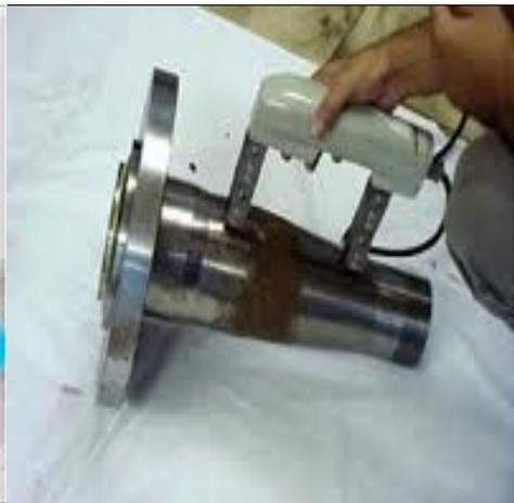
La magnetización de las piezas a examinar se puede realizar de dos formas diferentes como son: magnetización **por imanes** (utilizando potentes imanes o electroimanes), o **por corriente eléctrica** (puede ser por corriente eléctrica circular o longitudinal). La aplicación de las partículas magnéticas puede aplicarse **por vía seca** (en forma de polvo) o **por vía húmeda** (con medios acuosos o por disolventes sintéticos).
